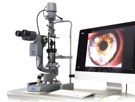
Questo strumento permette di esaminare l'occhio ingrandendo le immagini fino a 40 volte e orientando i fasci di luce bianca o colorata in modo da evidenziare le varie strutture dell'occhio e la presenza di eventuali patologie. Viene analizzato prima di tutto il segmento anteriore dell'occhio (sclera, congiuntiva, cornea, iride, forame pupillare, cristallino).
